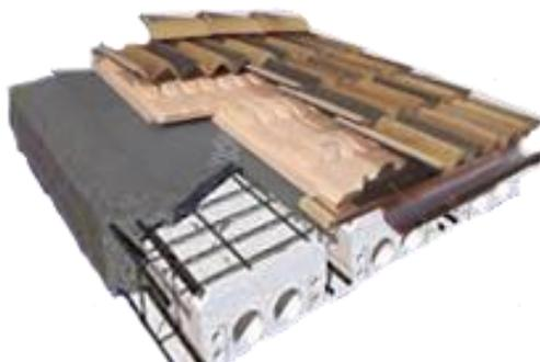
**STRUTTURA:** Cemento armato coibentato
