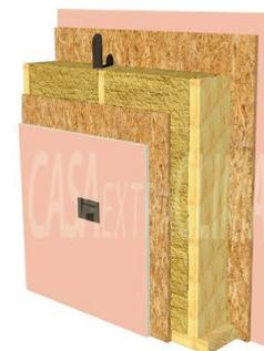
Divisori interni portanti, realizzati con struttura in legno, a telaio, secondo la seguente stratigrafia:
