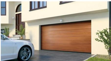
Per i locali adibiti a garage ed autorimessa, verranno previste adeguati portoni sezionali, in pannellature d'acciaio coibentate, con adeguare guarnizioni, per garantire il massimo isolamento e riparo da spifferi e polvere.
