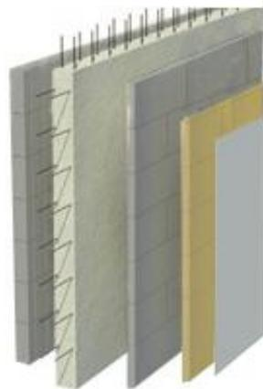
**STRUTTURA:** Cemento armato coibentato
