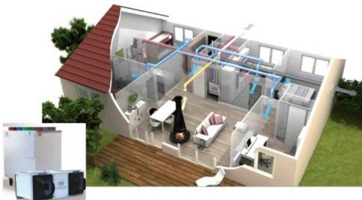
LA struttura verrà predisposta con un impianto di climatizzazione, deumidificazione e ricambio aria completo, marca Brofer.
