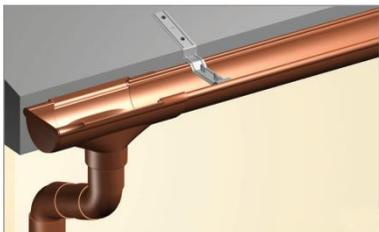
Le gronde, sono realizzate con la medesima tecnologia costruttiva del resto delle parti strutturali. Le grondaie saranno realizzate in lamiera d'acciaio o alluminio verniciato e sviluppo piano di 50 cm, fissate con cicogne e sovrapposizione chiodate e saldate a silicone. Sono compresi tutti i pezzi speciali per eseguire l'opera a regola d'arte.
